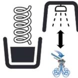
**Job Tankspülung (aus Spülwassertank an Tankreiniger, dann aus Haupttank an den Zerstäubern)**
