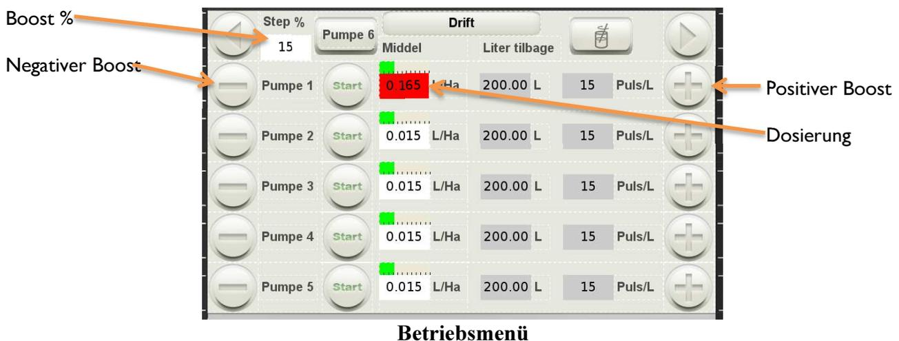
Läuft eine Pumpe mit Boost, leuchtet die relevante Zelle mit rot. Wenn zurück in den normalen Werten - auf die Zelle drücken.
