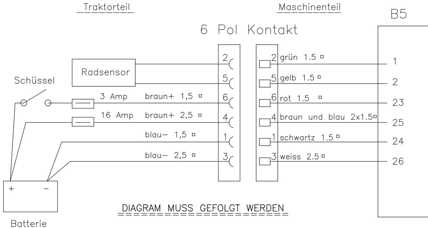
Die Spannung für die 20 Amp Sicherung muss direkt an der Batterie oder Anlasser angeschlossen werden.
