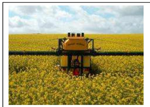
Das Gestänge wird von Drahtseilen getragen, die an der Gestängeaufhängung und an den beiden hinter der Innensektion montierten Türmen befestigt sind. Zur Gestängejustierung siehe **Kapitel 9.2.8** und **9.2.9**.
