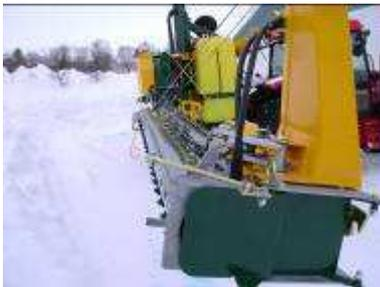
**Schritt 2 - Gestänge absenken, bis es in der Transporthalterung aufliegt.**
