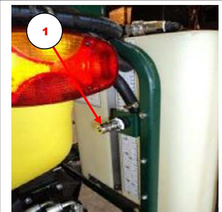
1. Efter endt sprøjting slukkes for injektionspumperne på PC SprayControlleren og der udsprøjtes fortsat ca. 50 m for at fortynde/tømme systemet.
