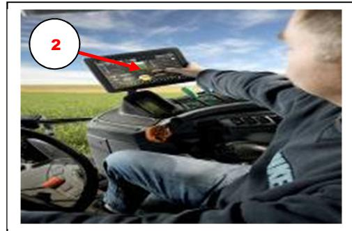
Alle funktioner styres fra én touchskærm og joystick. Den integrerede sprøjte-styring håndterer alle sprøjtenes funktioner, herunder regulering af lufttrykket, væskekontrol, al hydraulisk betjening, sporfølgende træk, bomhøjde-regulering, sektionsstyring, individuel bomløft, GPS-styring samt generel styring af andet ekstraudstyr.
