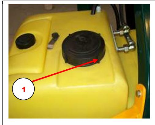
Rentvandstanken skal sikre, at sprøjtenes hydraulikolie ikke bliver overophedet. Dette sker ved at lade hydraulikolien løbe igennem en spiral(2) i rentvandstanken. Dette betyder samtidig at vandet i tanken er opvarmet.
